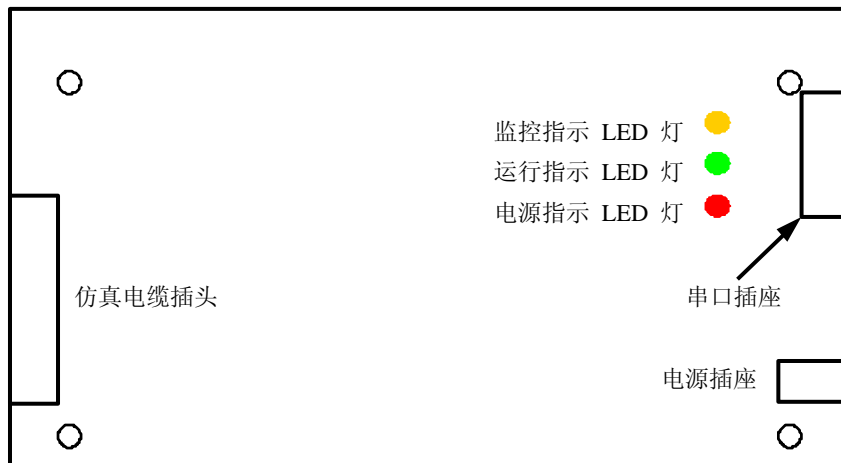
图 7.1 TKS-764B 平面图(顶部俯视)
